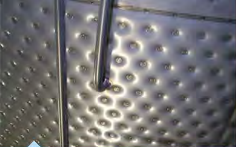
Кольцевая сварка испарителя оптимизирует поток хладагента
