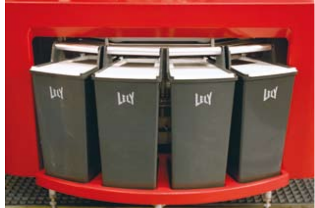
Le robot de traite Lely Astronaut sépare le colostrum pour les veaux.
